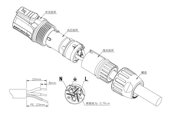
此产品标配两款线夹防水圈,适用线径不同,客户可根据适配线径自行更换,如下:
